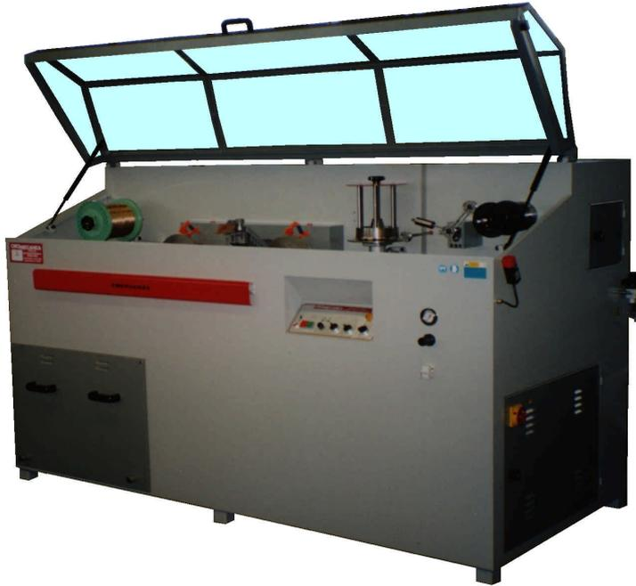
Macchina studiata per soddisfare le esigenze di trafilatura ad alta velocità del filo di diametro max 2 mm nel settore dell'oreficeria ed argenteria.
